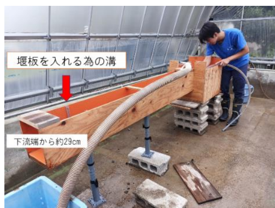
図2. 室内実験に使用した水路.
