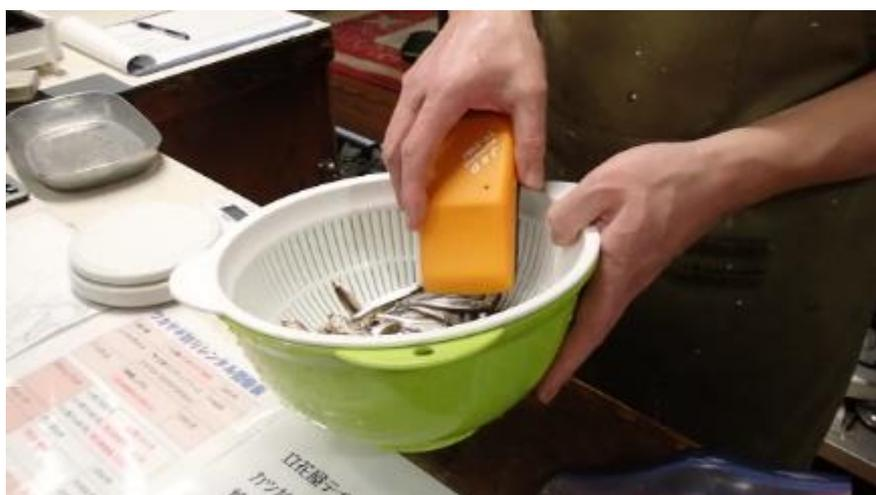
図7 検針器による検針の様子
